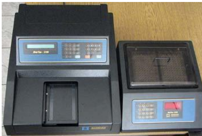
Рис.13. Микропланшетный спектрофотометр «StatFax 2100» (А) и инкубатор/шейкер Stat Fax 2200 (Awareness Technology INC)(Б)
