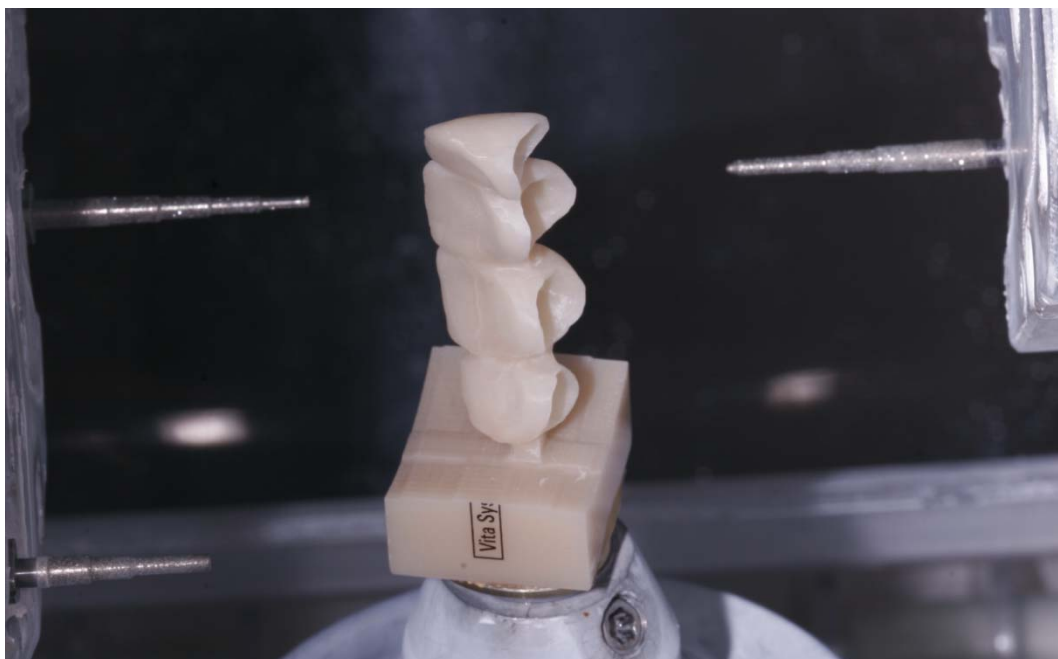
Рис. 50. Фрезерование несъемной конструкции на фрезеровочном блоке CAD/CAM системы CEREC in Lab MCXL
