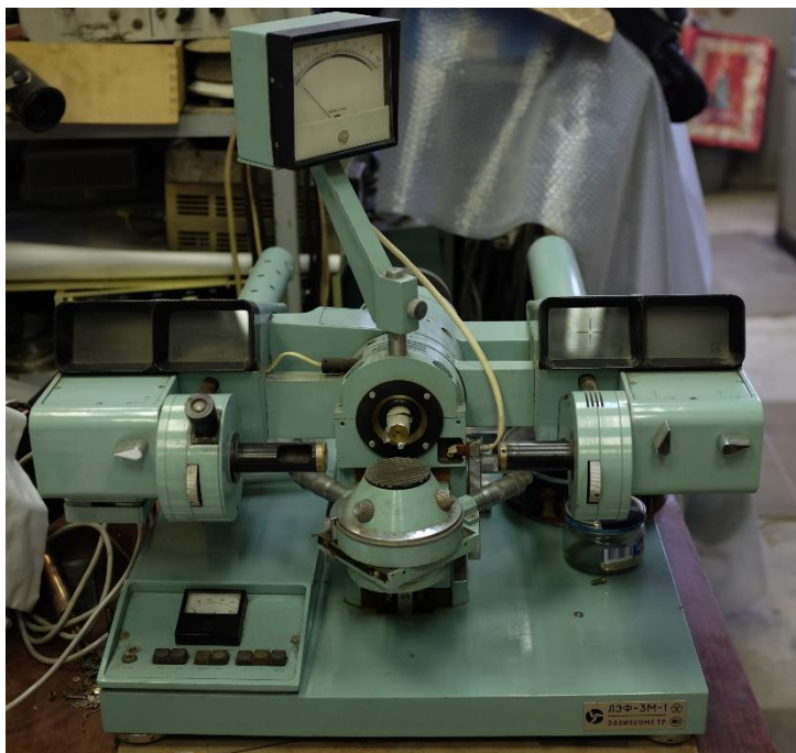
Рисунок 21 — Эллипсометр ЛЭФ-3М-1 для определения толщины покрытия «Панцирь» на образцах зубных протезов.
