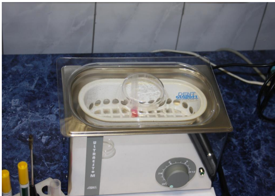
Рисунок 45 — Обработка образца стоматологической пластмассы с тест-штаммом в ультразвуковой ванночке «UltraEst-M» (ООО «Геософт», РФ).
