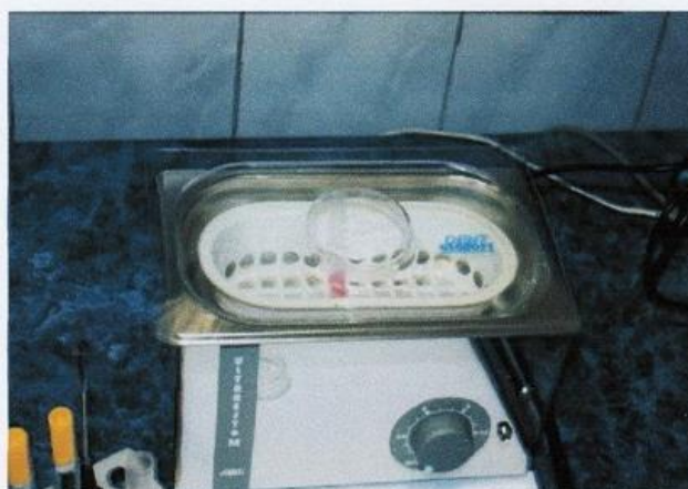
Рис. 3. Обработка образца стоматологической пластмассы с тест-штаммом в ультразвуковой ванночке «UltraEst-M» (ООО «Геософт», РФ).
