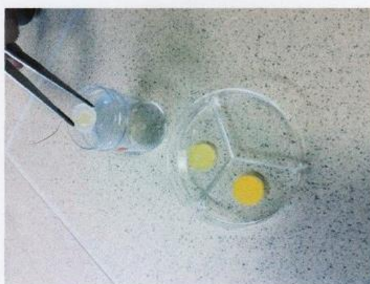
Рис. 2. Перенос образца с нанесённым тест-штаммом в ёмкость для последующей ультразвуковой обработки.
