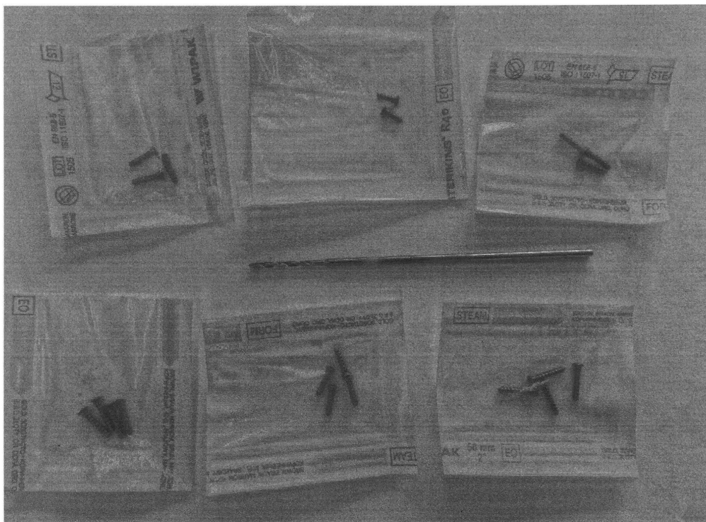
Фиг.11 Внешний вид сверла и винтов для челюстно-лицевой хирургии с покрытием из карбида кремния.
